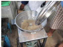
Gambar 2. Proses Penggilingan Rumput Laut
