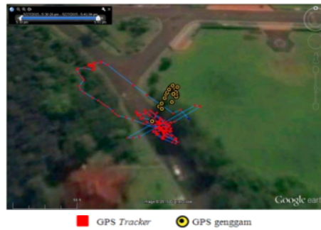
Gambar 6. Plot hasil uji coba stasiun pada area yang diberi penghalang Figure 6. Results plot of the stationer test in the area that is given a barrier
